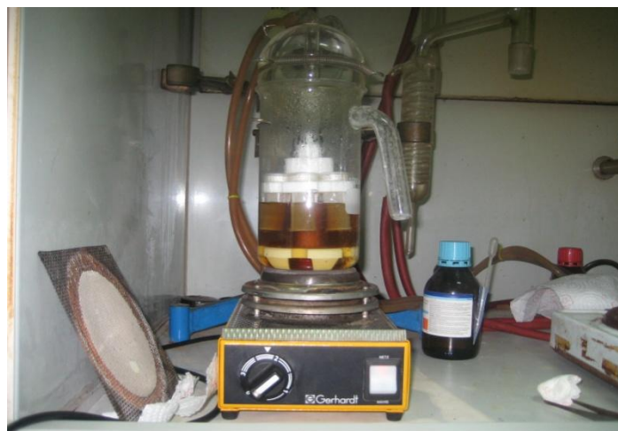
Slika 10 Kuhanje uzorka u razrijeđenoj sumpornoj kiselini (Jozinović, 2011.)
