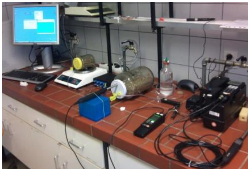
Slika 11 Prikaz laboratorijskog horizontalno – cilindrično staklenog bioreaktora s pripadajućom opremom
