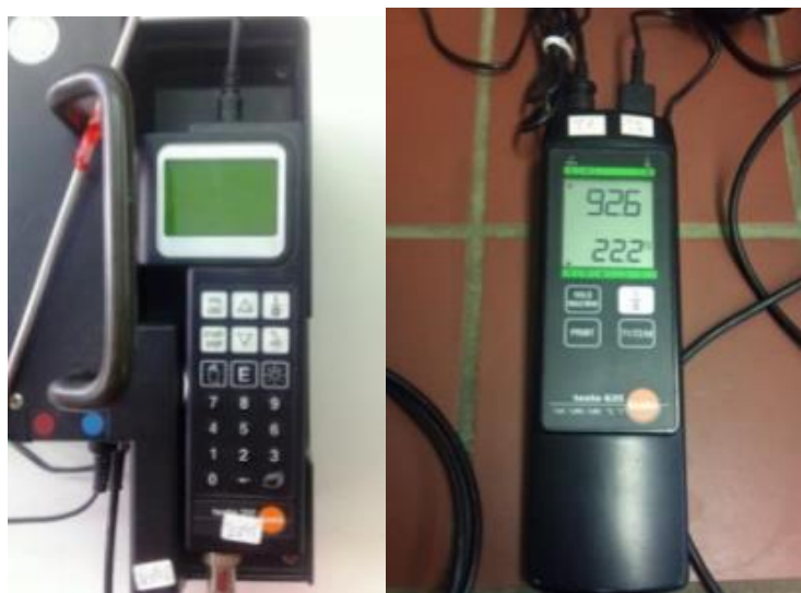
Slika 8 Prikaz uređaja Testo 350 i Testo 635 za mjerenje temperature i relativne vlažnosti
