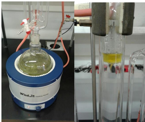
Slika 18. Vodena destilacija ploda konopljike (Izvor autor)
