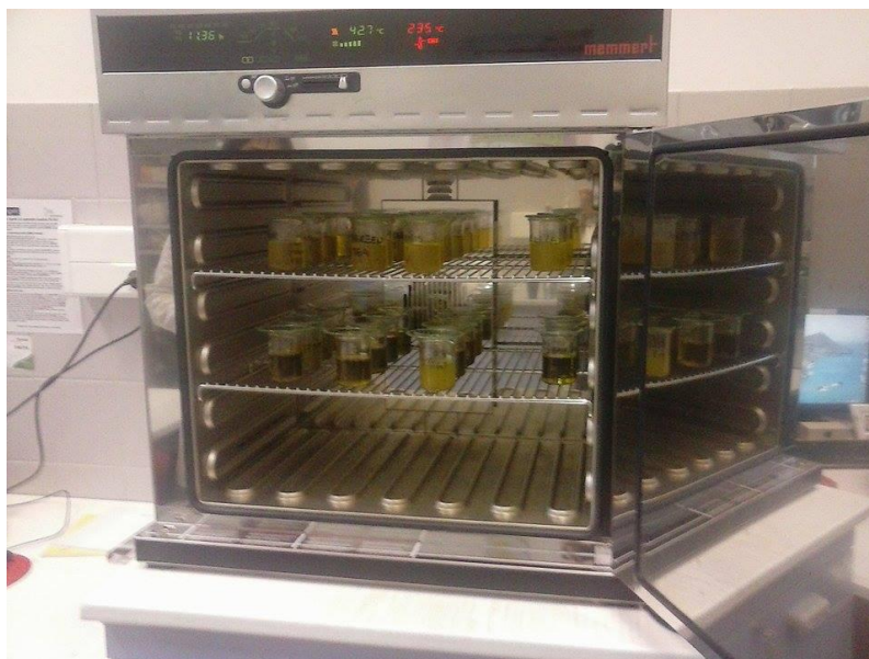
Slika 14 Termostat s pripremljenim uzorcima ulja sa i bez dodanih antioksidanasa
