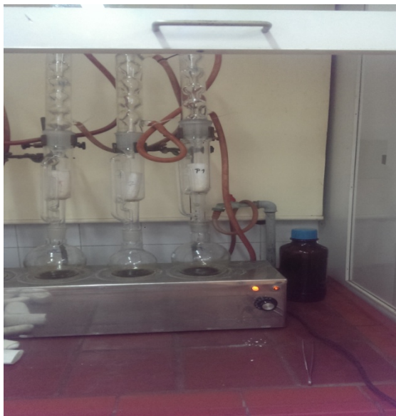
Slika 13. Aparatura za ekstrakciju ulja po Soxhlet-u
