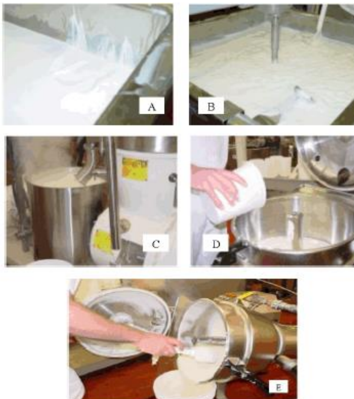
Slika 7 Postupci proizvodnje krem sira: A – zakiseljeni mliječni gel (pH=4,7-4,8); B – zagrijavanje i miješanje; C – odvajanje sirutke centrifugalnim separatorom; D – dodavanje soli i stabilizatora; E – pakiranje zagrijanog sira (Phadungath, 2005.).
