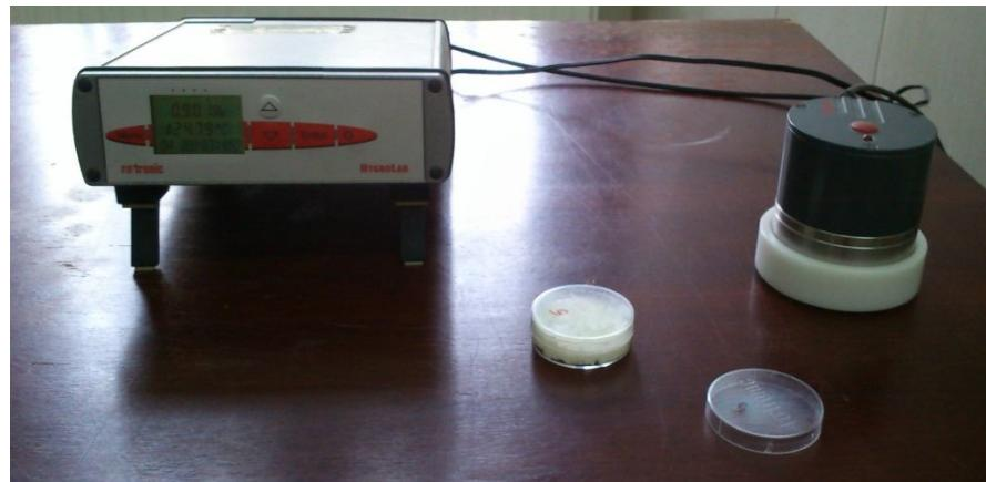
**Slika 4 HygroLab 3 (uređaj za mjerenje aktiviteta vode)**
