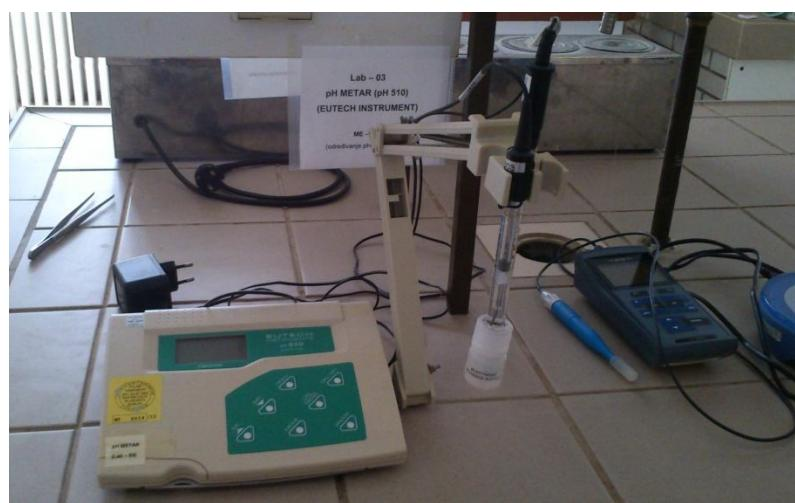
**Slika 5 Ubodni pH metar (WTW)**
