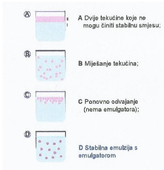
Slika 2 Shematski prikaz djelovanja emulgatora ( http://www.fkit.unizg.hr/ )
