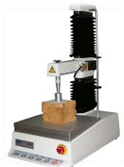
Slika 6. TA.XT Plus TextureAnalyzer
