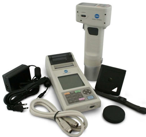
Slika 8. Kolorimetar (KonicaMinoltaChromaMeter CR-400)
