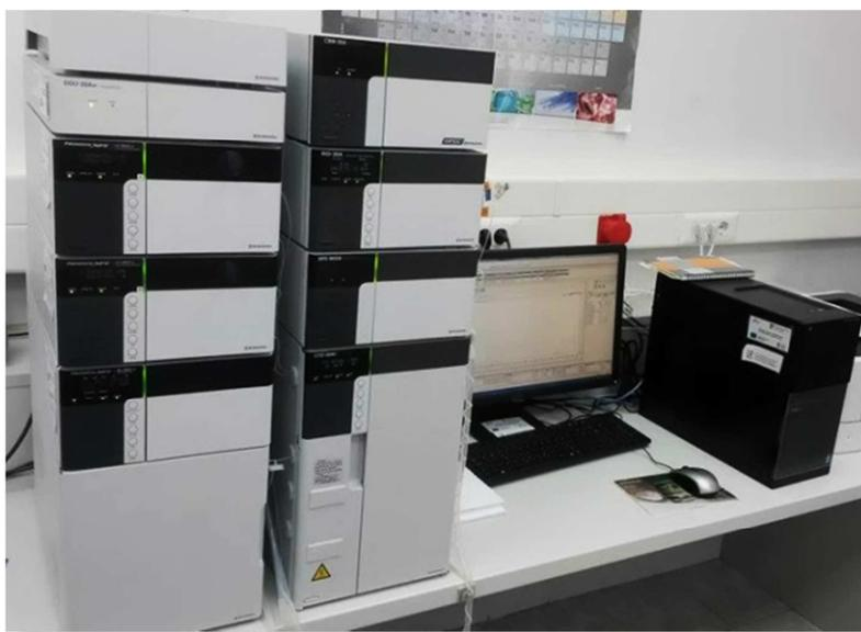
**Slika 9.** Nexera XR UHPLC, Shimadzu
