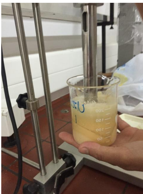
Slika 5. Prikaz procesa homogenizacije sa laboratorijskim homogenizatorom
