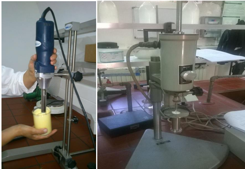
Slika 4. Na slici lijevo prikazan je laboratorijski homogenizator Wiggenhauser, na slici desno je model D-500 i rotacijski viskozimetar Rheomat 15T
