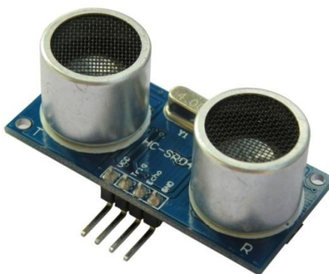
Slika 8 Ultrazvučni pretvornik HCSR-04 (Cytron Technologies Sdn. Bhd., 2014).
