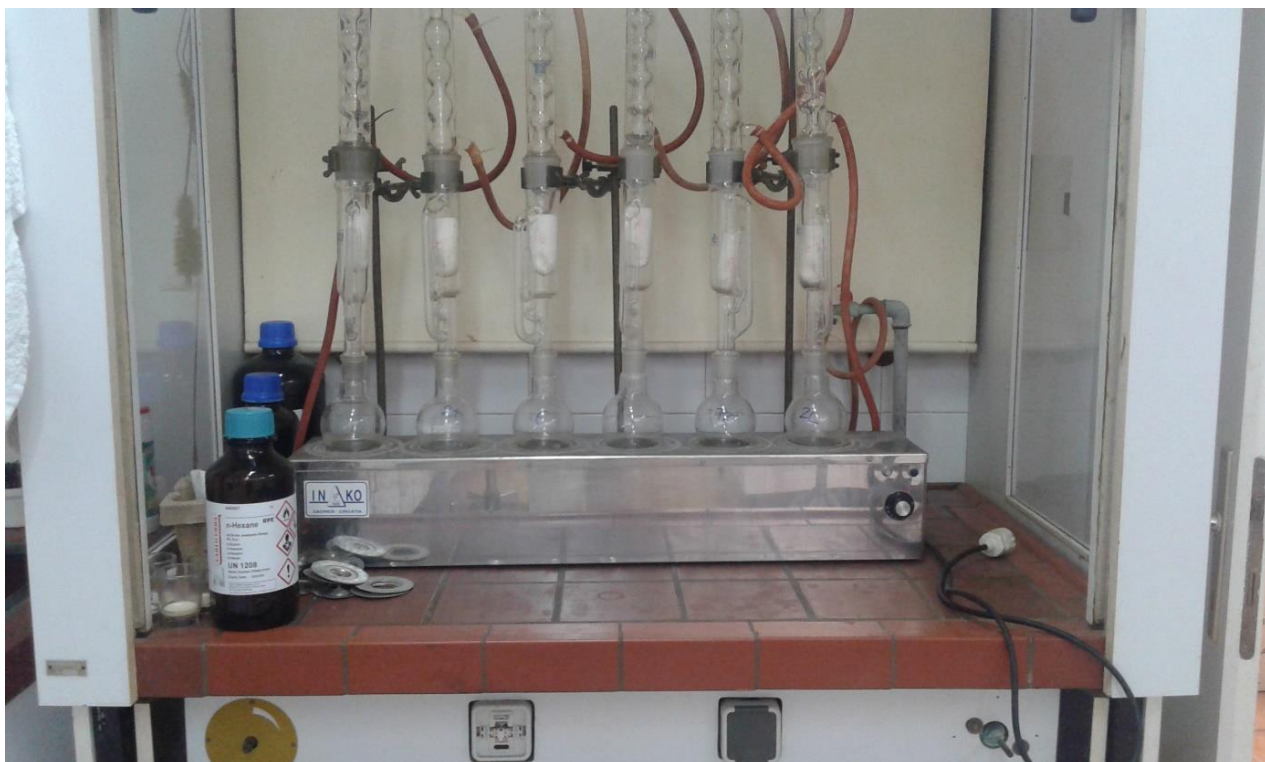
Slika 6 Aparatura za ekstrakciju ulja po Soxhlet-u
