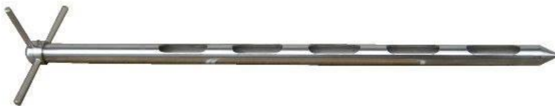
Slika 16. Ručna sonda za uzorkovanje ječma (Web 9)
