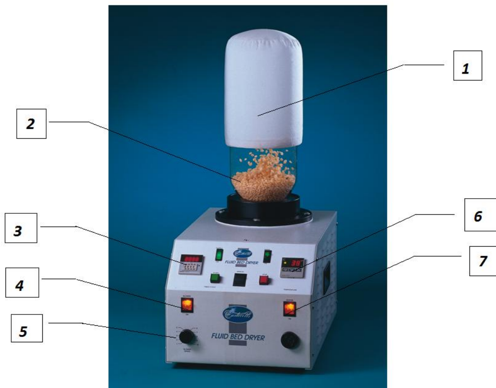
Slika 7 Sušionik s fluidiziranim slojem (1 - filter vrećica; 2 - kolona; 3 - prikaz vremena; 4 - prekidač ventilatora; 5 - regulator brzine rada ventilatora; 6 - prikaz temperature; 7 - prekidač grijača)
