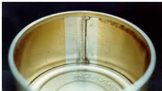
Slika 7 Korozija omotača limenke
