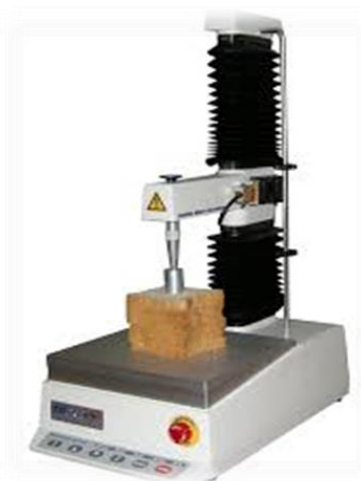
Slika 13. Uređaj TA.XT Plus TextureAnalyzer
