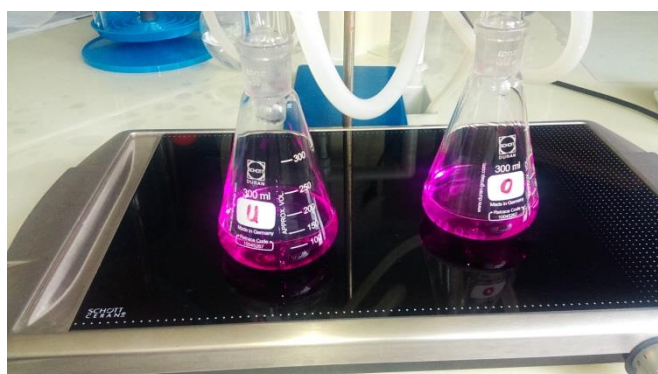
Slika 5 Prikaz određivanje kiselina u etanolu
