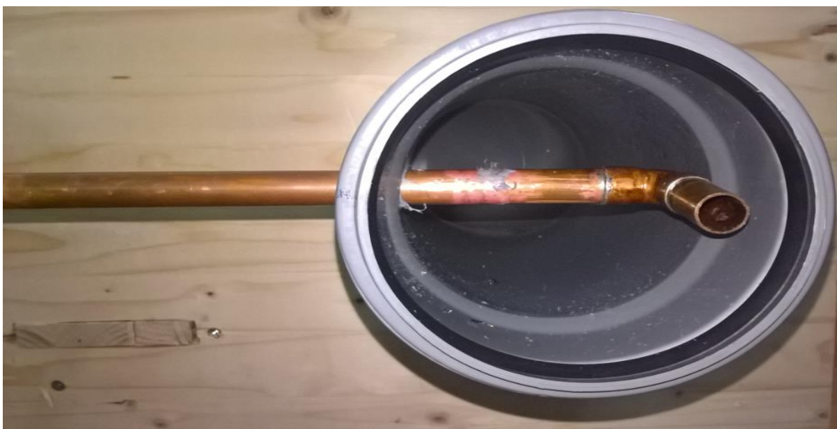
Slika 14 Bakreno koljeno lemljeno legurom cinka i kositra
