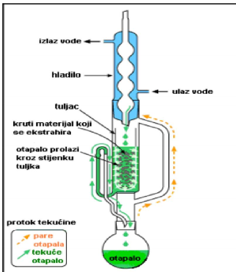
**Slika 6** Shematski prikaz Soxhlet-ovog ekstraktora (Primorac i Flanjak, 2012).
