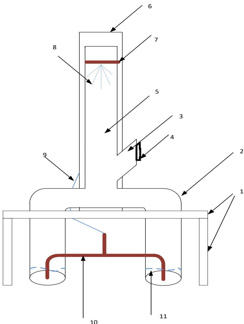
**Slika 7** Skica rashladnog tornja: 1-postolje s nogama, 2-koljena spojena na cijev, 3-jednostrana kosa račva, 4-ventilator, 5-cijev, 6-drvena, 7-bakrena cijev probušena u sredini, 8-topla voda, 9-gumeno crijevo, 10-bakrene cijevi, 11-ohlađena voda
