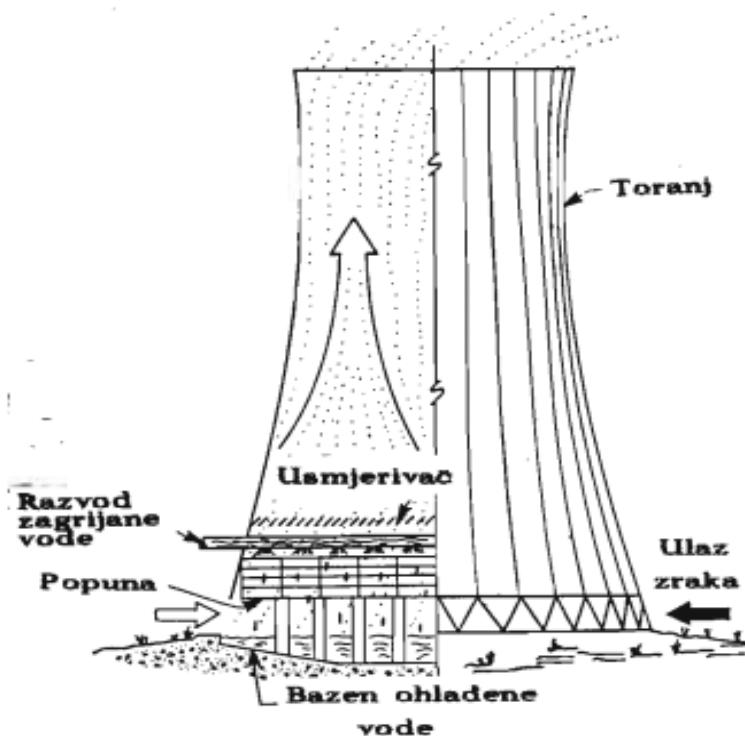
*Slika 5* Vlažni rashladni toranj s paralelnim strujanjem (Guzović, 1996).
