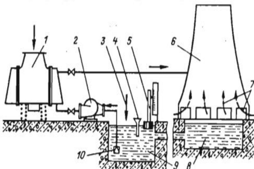
**Slika 3** Zatvoreni rashladni sustav s rashladnim tornjem: 1-kondenzator, 2-pumpa za rashladnu vodu, 3-dodavanje vode, 4-uvođenje klor-a, 5-pokazivač razine, 6-rashladni toranj, 7-ulaz atmosferskog zraka u rashladni toranj, 8-sabirni bazen, 9-sabirni kanal, 10-nepovratni ventil pumpe (Guzović, 1996).
