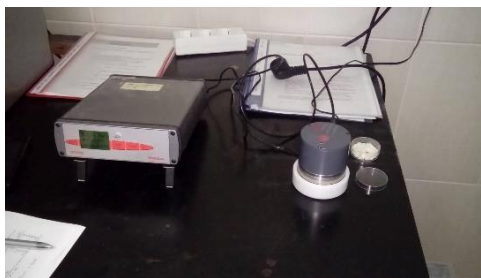
Slika 17 HygroLab 3 (uređaj za određivanje aktiviteta vode)
