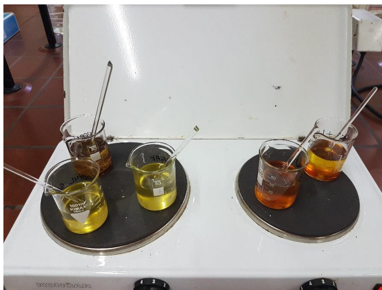
Slika 19 Zagrijavanje uzoraka na 70 °C kroz 30 minuta
