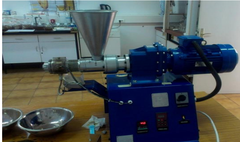
Slika 5 Pužna preša tipa SPU 20 (Aladić, 2015)
