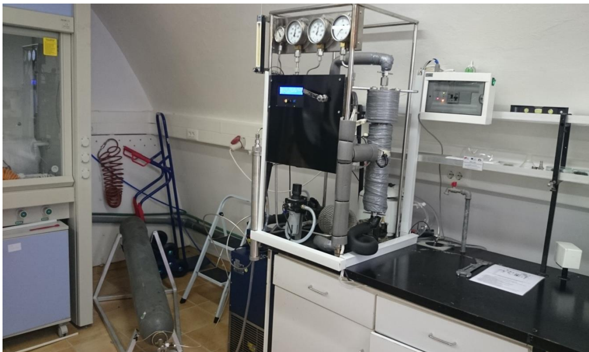
Slika 9 Uređaj za superkričnu ekstrakciju (Aladić, 2015)
