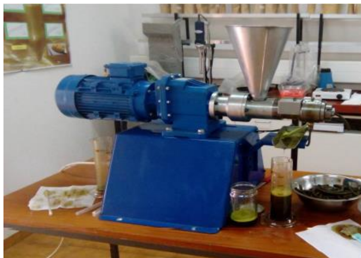
Slika 4 Pužna preša, Prehrambeno-tehnološki fakultet Osijek
