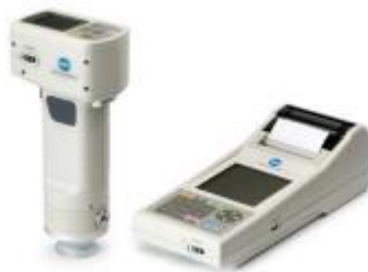
Slika 4 Kromametar Konica Minolta CR-400 (Jozinović, 2015)
