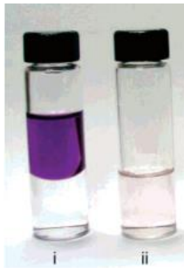
Slika 5. Fuleren otopljen u: i) toluenu, ii) tetrahidrofuranu [Fortner i sur. 2005.]
