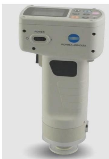
Slika 6 Kromametar Konica Minolta CR-300 (Tanasković, 2014.)
