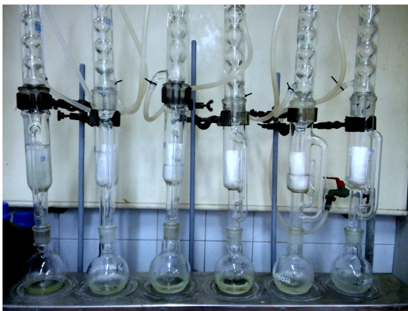
Slika 18 Ekstrakcija ulja po Soxhlet-u
