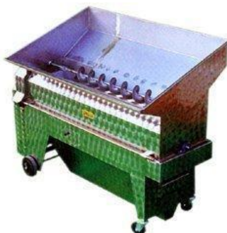
Slika 9 Električna runjača-muljača za grožđe (Web 11)
