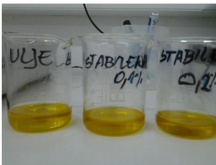
Slika 9 Boja ulja s i bez dodanog antioksidansa ekstrakt ružmarina tip StabilEnhance OSR nakon četiri dana testa
