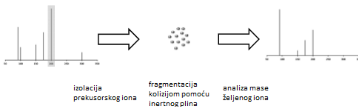
Slika 6 Shematski prikaz rada MS/MS sustava (prilagođeno iz Madeira i Florêncio, 2012)
