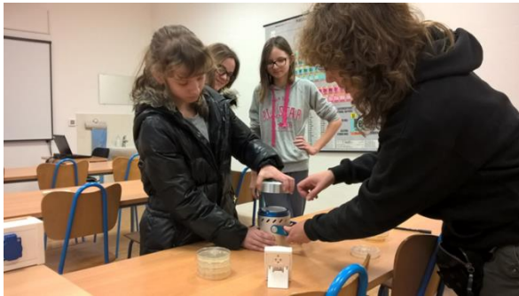
Slika 14 Uzimanje uzorka zraka za određivanje broja i sastava plijesni (mikološka analiza)
