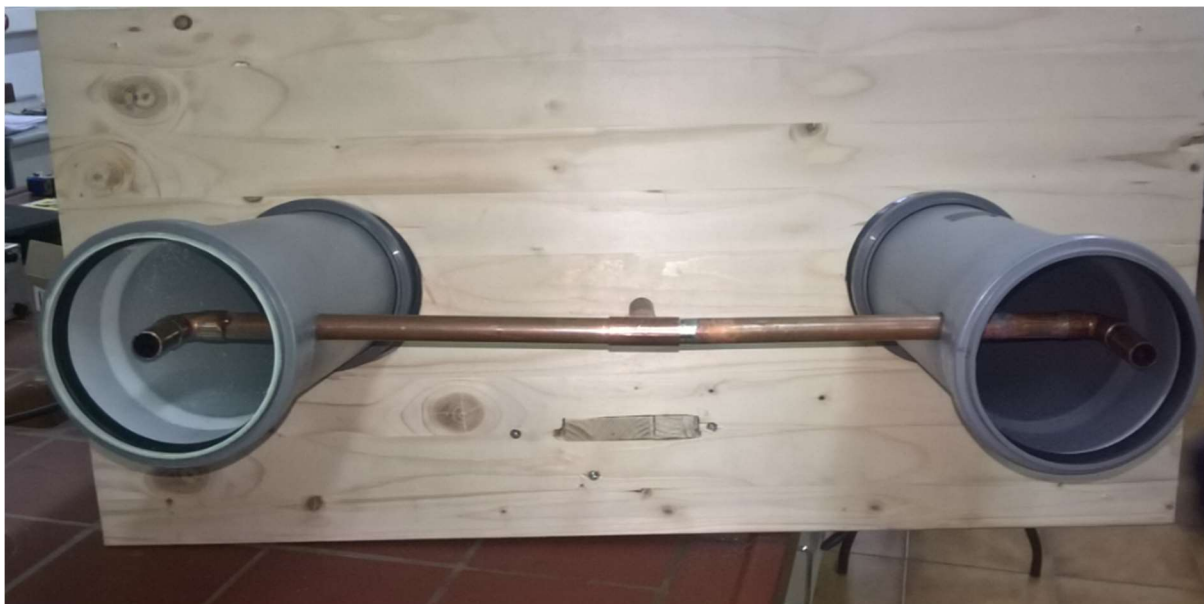
Slika 13 Bakrena cijev s koljenima provučena kroz plastične cijevi
