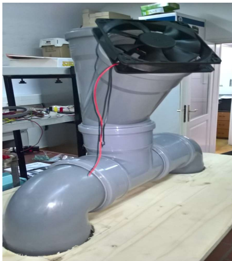
Slika 12 Ventilator pričvršćen na rub cijevi
