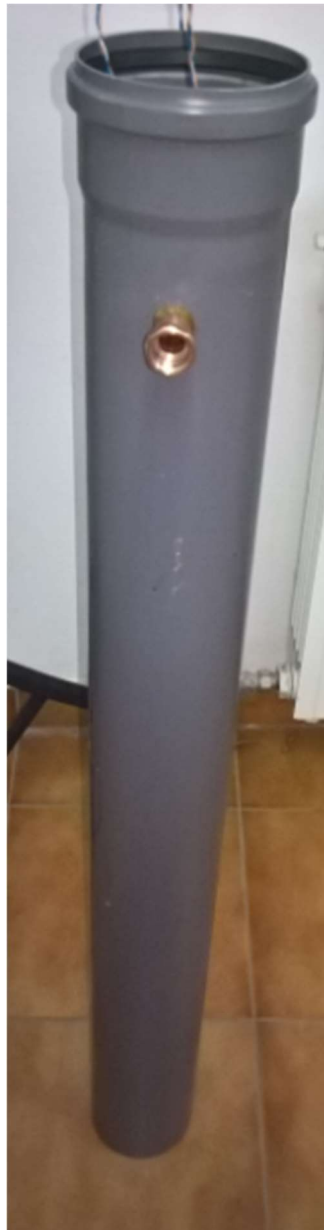
Slika 15 Prikaz gornje cijevi kroz koju prolazi bakrena cijev
