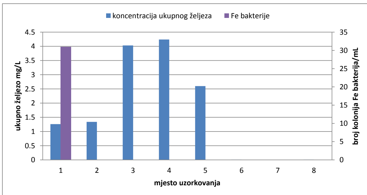
Slika 42 Ovisnost pojavnosti željeznih bakterija o koncentraciji ukupnog željeza u vodi iz pogona za preradu vode i vodi na mjestu potrošnje pri uzorkovanju br. 4
