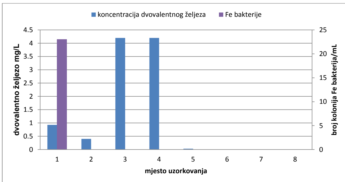
Slika 46 Ovisnost pojavnosti željeznih bakterija o koncentraciji dvovalentnog željeza u vodi iz pogona za preradu vode i vodi na mjestu potrošnje pri uzorkovanju br. 2
