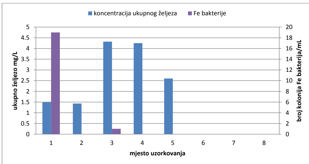
Slika 36 Ovisnost pojavnosti željeznih bakterija o koncentraciji ukupnog željeza u vodi iz pogona za preradu vode i vodi na mjestu potrošnje pri uzorkovanju br. 1
