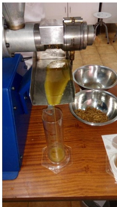
Slika 19 Hladno prešanje pužnom prešom (proizvodnja sirovog ulja i pogače)
