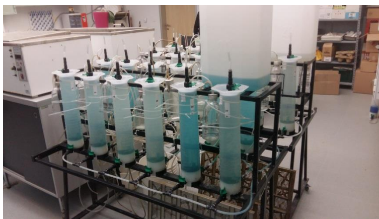
Slika 3.5. Aparatura za proizvodnju bioplina
