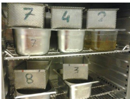
Slika 10. Slađenje pšenice u CLIMACELL komorici
