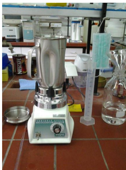
Slika 11. Ekstrakcija u laboratorijskom blenderu
