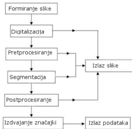
Slika 14. Proces obrade i analize digitalne slike
