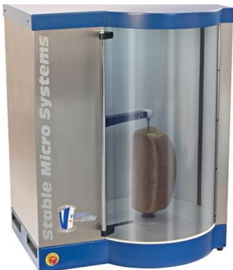
**Slika 4** Volscan Profiler, uređaj za mjerjenje volumena
