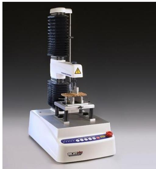
**Slika 5** TA.XT Plus, uređaj za određivanje teksture
