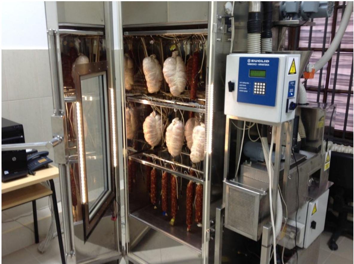
Slika 16 Automatizirana komora za zrenje kulena
