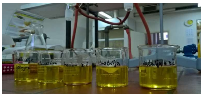
Slika 14 Uzorci za ispitivanje oksidacijske stabilnosti testom održivosti na 98 °C
