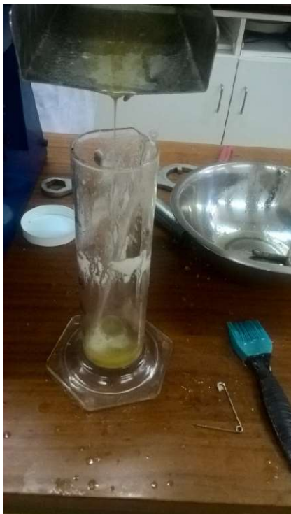
Slika 8 Mjerenje volumena i temperature sirovog ulja
