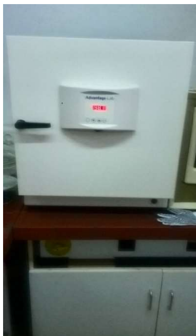
Slika 16 Sušionik zagrijan na temperaturu 98 °C
