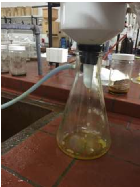
Slika 6. Vakuum filtracija sirovog ulja (Izvor: autor)
