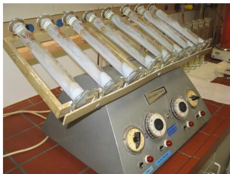
Slika 1 Uređaj za određivanje sedimentacijske vrijednosti po Zeleny-u
