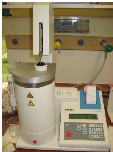
Slika 6 Uređaj za određivanje FN po Hagberg-Pertenu
