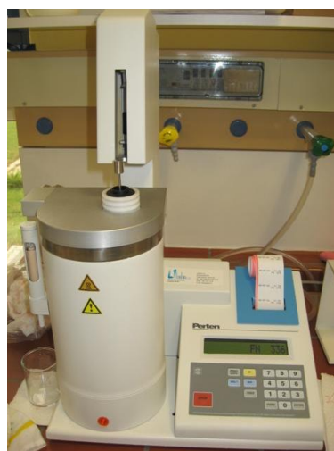
Slika 6 Uređaj za određivanje FN po Hagberg-Pertenu
