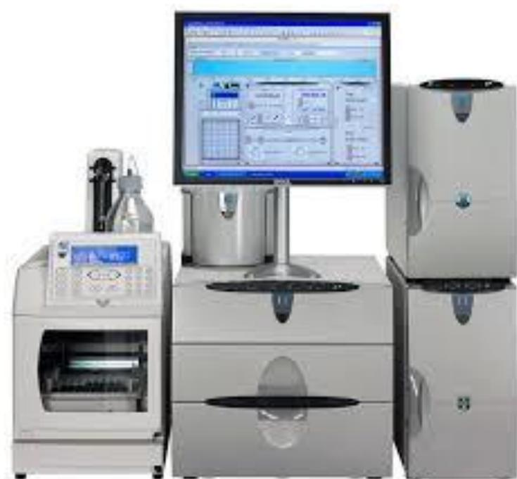
Slika 6: ICS-3000 uređaj za kromatografiju
