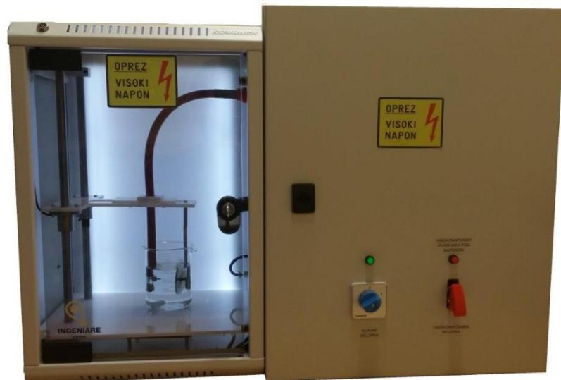
**Slika 14** Uređaj za tretiranje hladnom plazmom (PTF, Osijek)
