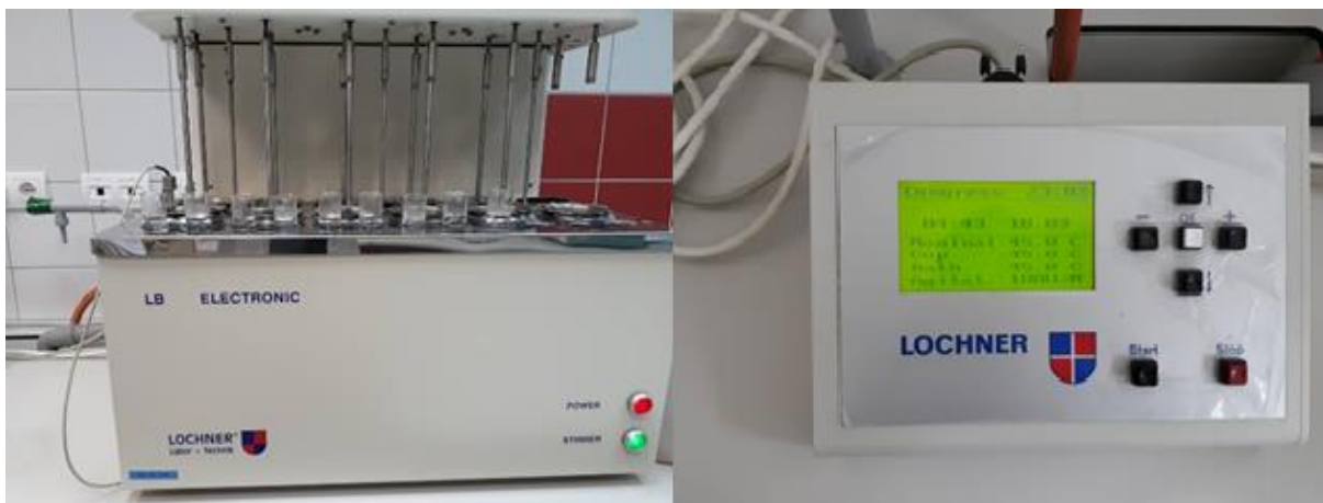
Slika 5 Uređaj na kojem se provodi kongresna metoda ukomljavaanja slada
