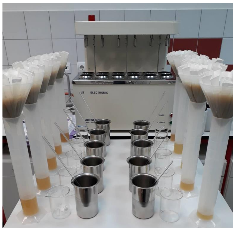
Slika 6 Filtracija dobivene sladovine
