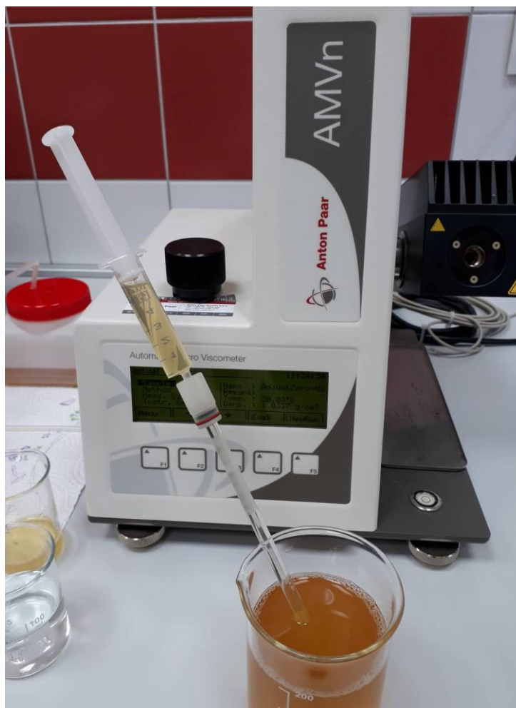
Slika 7 Uzimanje uzorka za mjerenje viskoznosti kongresne sladovine
