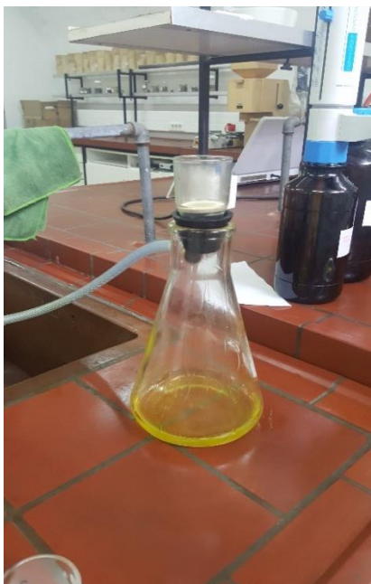
Slika 11 Postupak filtriranja ulja preko staklenog lijevka s perforiranim dnom
