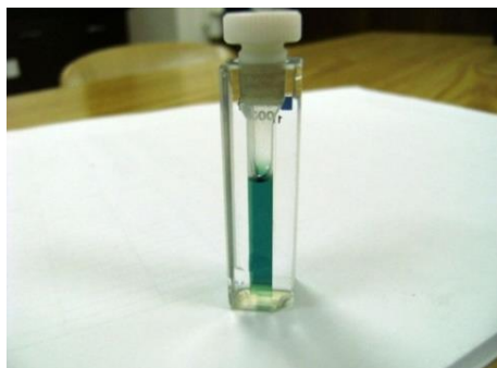
Slika 3.10. Obojenje nastalo oksidacijom ABTS-a lakazom
