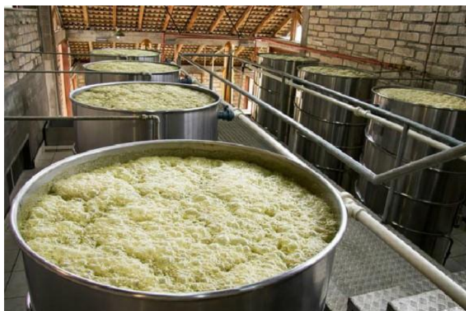
Slika 3 Pojava viskozne pjene tijekom fermentacije
