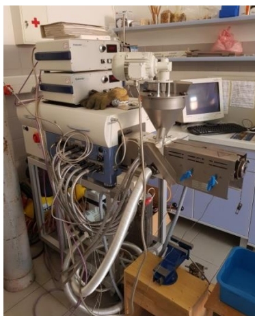
Slika 13 Jednopusni laboratorijski ekstruder Brabender 19/20 DN
